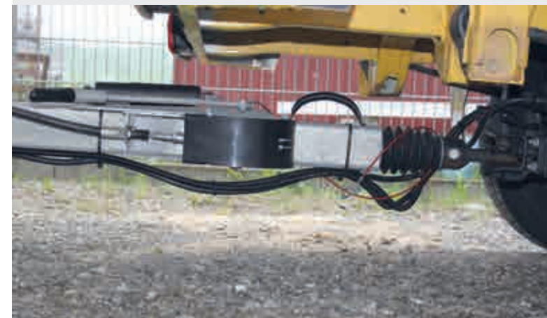
Zentrale Kupplungsaufnahme, direkt hinter der Achse des Zugfahrzeuges
