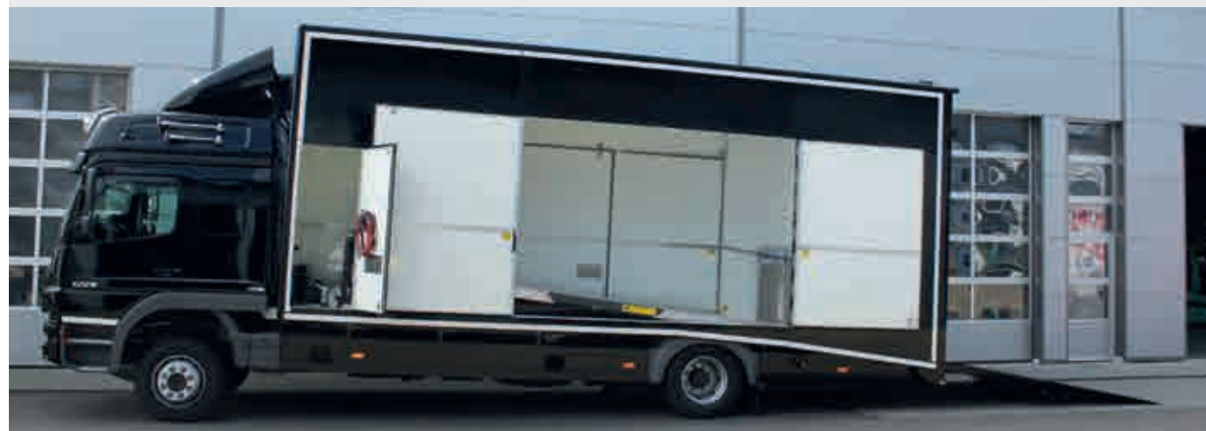
Flache Auffahrverhältnisse durch beidachsige Luftfederung
