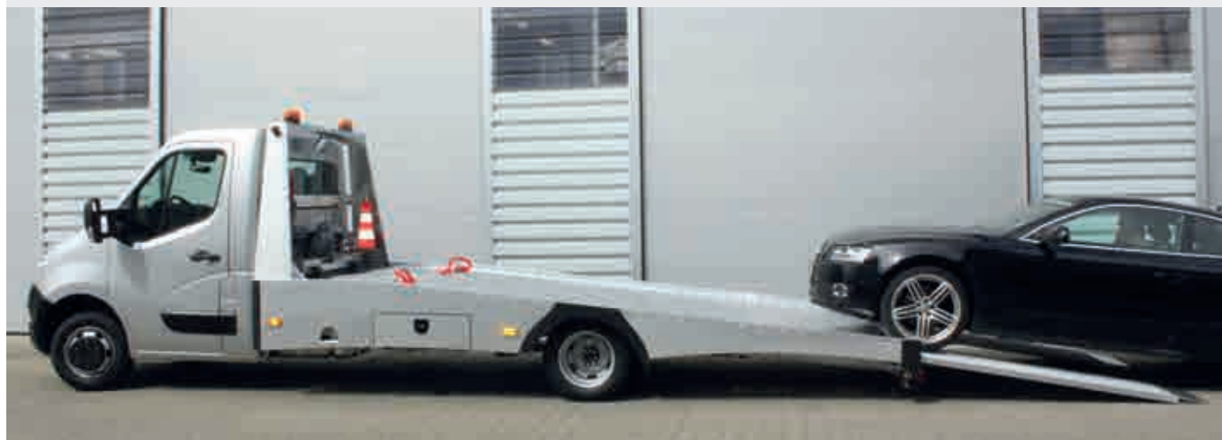
Flache Auffahrverhältnisse – hydraulische Schienen
