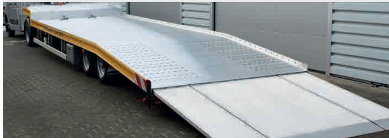
Perfekt – hydraulische Laderampe, Verzurrung nach VDI 2700 8.1 / 8.2
