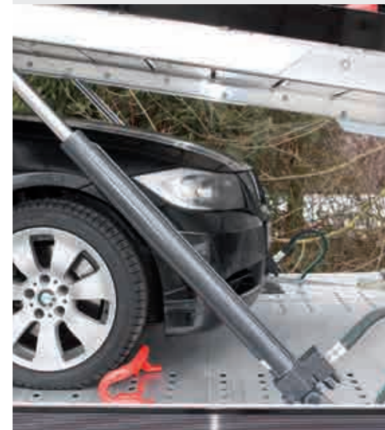
Patentierte selbstsichernde Zylinder
