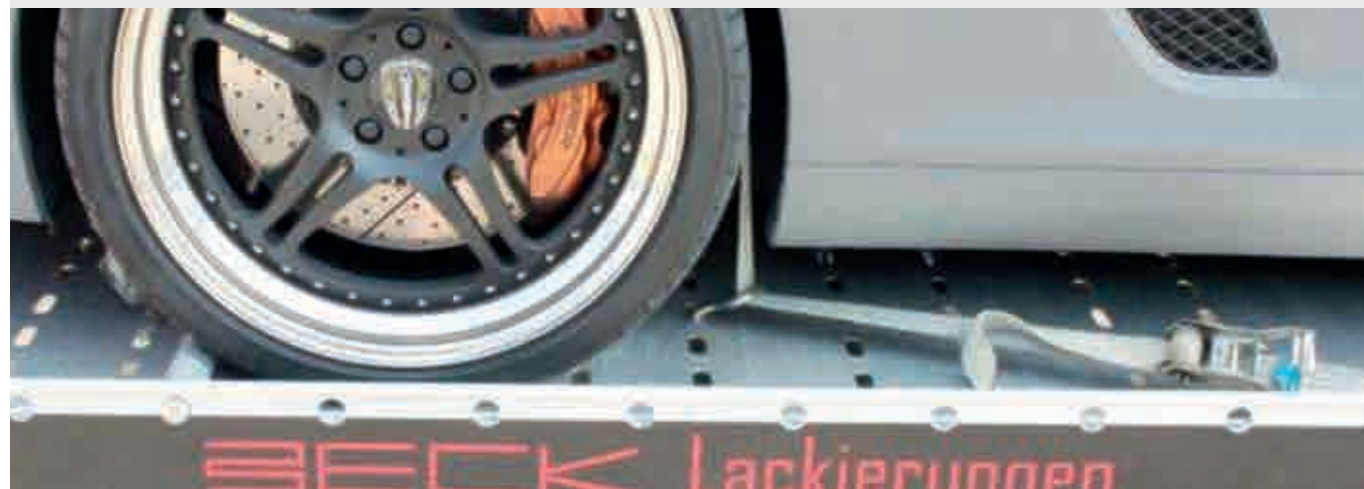
Drei-Punkt-Verzurrung – erfüllt die VDI 2700 8.1/8.2
