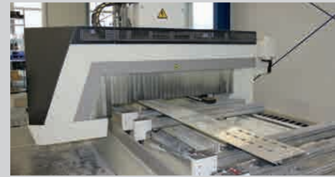
Bearbeitungszentrum 6,5 x 1,5 m
